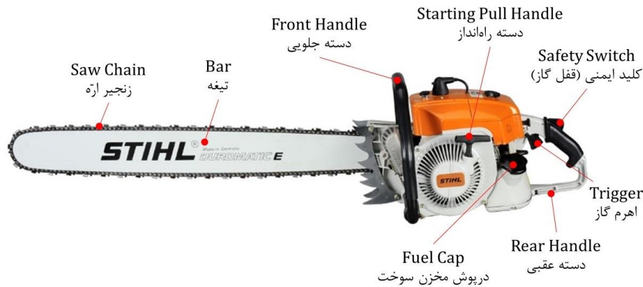
شکل ۱- ارّه موتوری و اجزای آن
