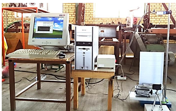
شکل ۱- دستگاه سقوط آزاد و اجزای آن؛ (۱) لودسل تک نقطه‌ای و پایه نگهدارنده، (۲) سامانه مونتورینگ لودسل، (۳) کامپیوتر، (۴) شیر خلا، (۵) دوربین، (۶) استوانه فولادی، (۷) میله مدرج و (۸) صفحه سفید مدرج
