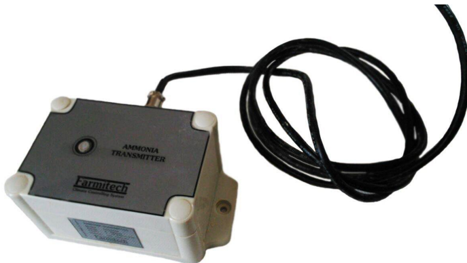
شکل ۳- ماژول اندازه گیری آمونیاک با سنسور آمونیاک مدل RS485
