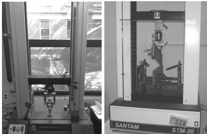
شکل 1- تجهیزات ساخته شده برای نصب تیغه‌های ماشین بسته‌بندی روی دستگاه بارگذاری چندمنظوره در آزمون‌های بخش ایران (راست) نصب پروب وارنر براتزلر برای آزمون برشی در آزمون‌های بخش آمریکا (چپ)
