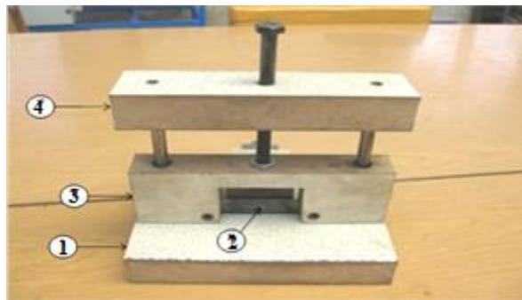
شکل ۱- دستگاه برش: (۱) شاسی، (۲) تیغه، (۳) فک ثابت و (۴) فک متحرک
