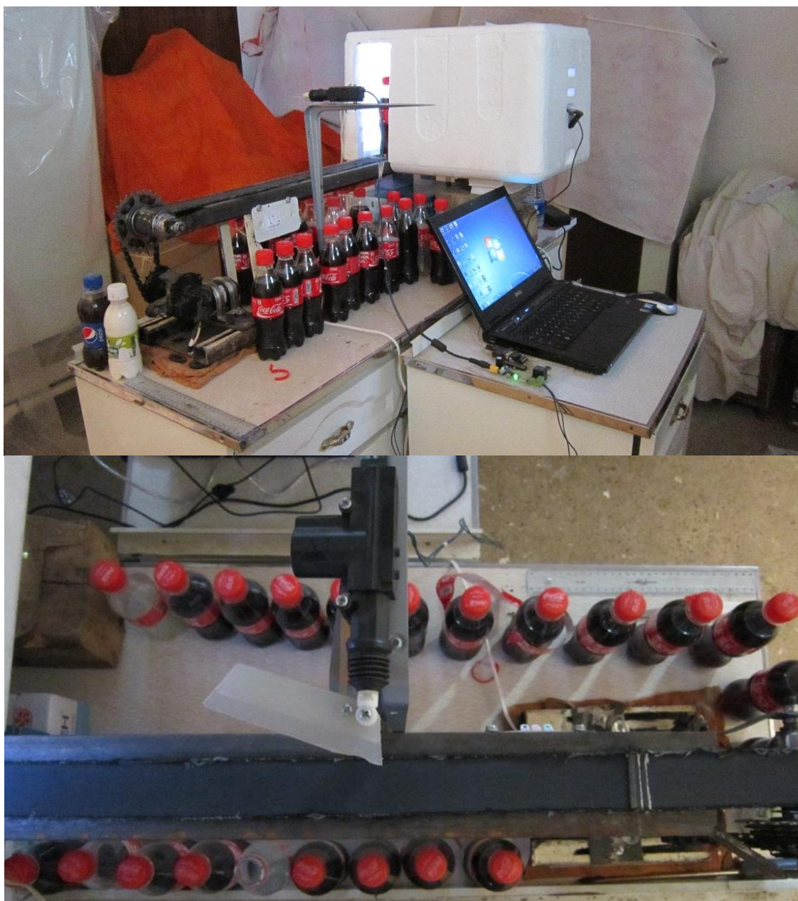
شکل ۴- نمای کامل سامانه ماشین بینایی برای بازرسی بطری‌های معیوب
