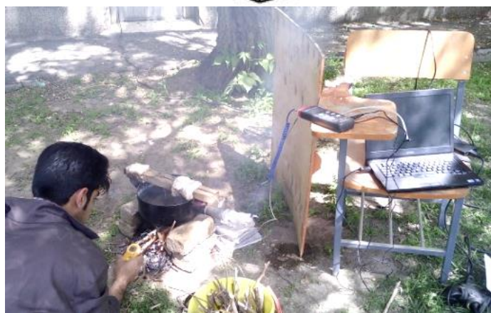
شکل ۲- هندسه اتاق آزمون تعیین میزان انتشار CO (بالا)، آزمایش در فضای باز (پایین) Fig. 2. The geometry of the CO emission test room (up), outdoor test (down)
