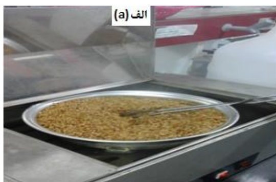
شکل ۱- فرآیند خیساندن و بخاردهی (الف) بن ماری جهت ثابت نگه داشتن دمای آب (ب) بن ماری جهت بخاردهی
