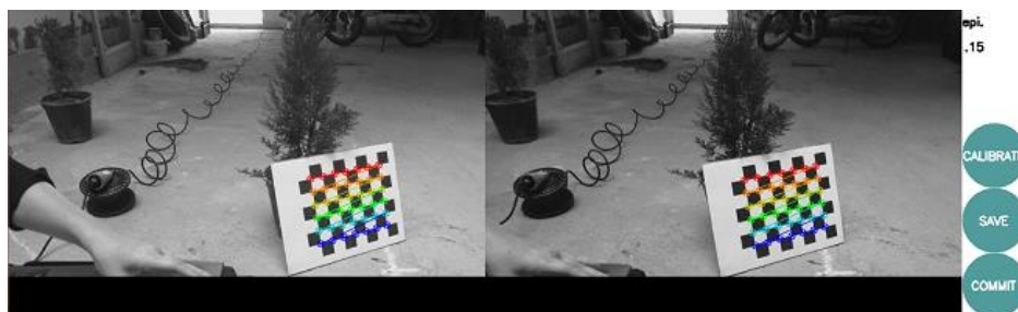
شکل ۵- نتیجه کالیبراسیون دوربین استریو Fig. 5. Result of stereo camera calibration
