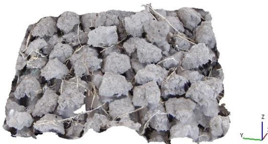
شکل ۴- یک نمونه از مدل سه‌بعدی حاصل از تصویر استریو از کلوخه‌های حاصل از شخم
