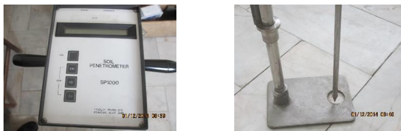
شکل ۲- فروسنج Fig.2. Penetrometer
