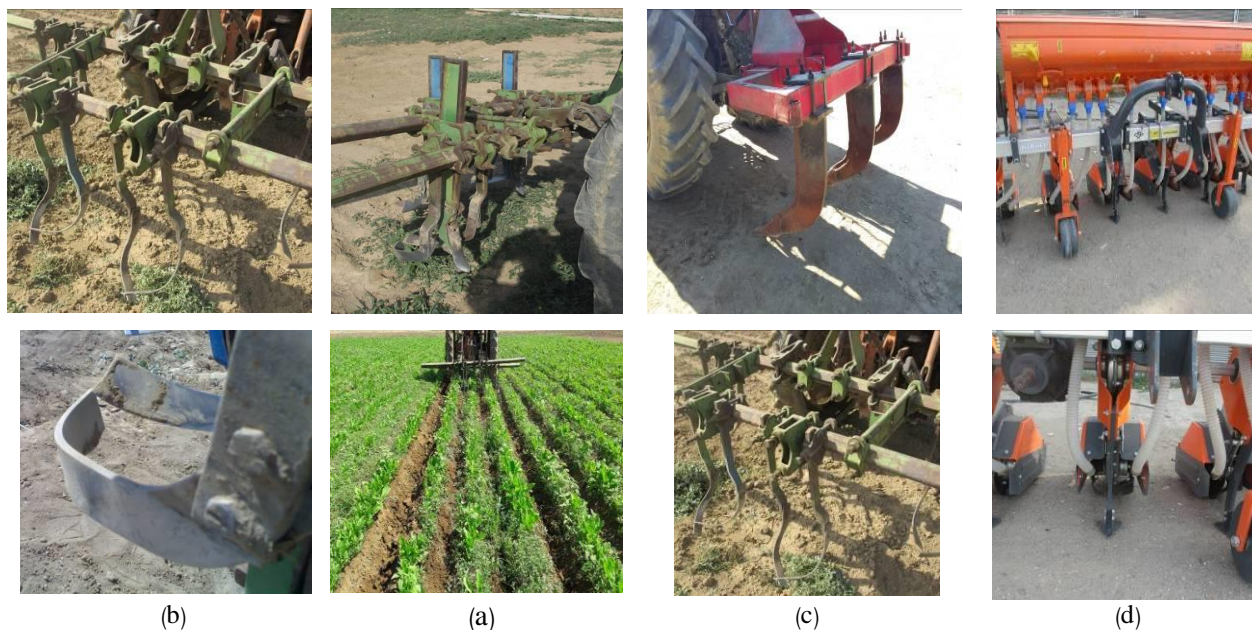
شکل ۱- خاک‌ورزهای بین ردیفی (a- کولتیواتور مرکب مجهز به تیغه‌های قلمی و هلالی، b- کولتیواتور هلالی، c- کولتیواتور هلالی + نیمه‌زیرشکن و d- ماشین مرکب روتیواتور بین ردیفی مجهز به کولتیواتور دوار و تیغه پنجه‌غازی)
