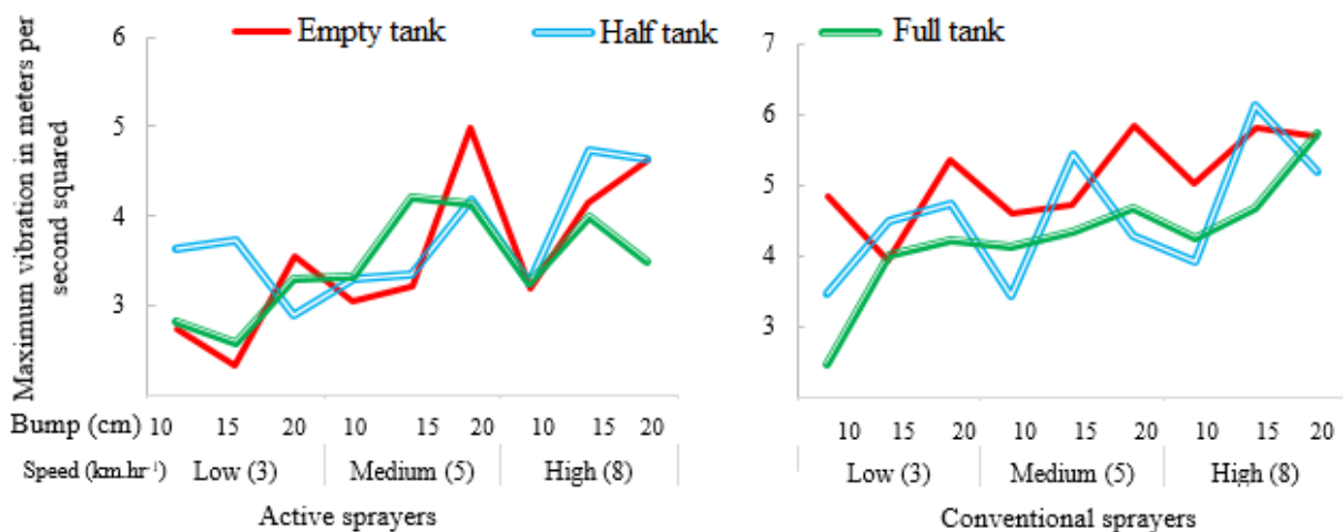
شکل ۱۱- شتاب‌های بحرانی سمپاش‌ها برحسب متر بر مجذور ثانیه Fig.11. Critical accelerations of sprayers in meters per second squared
