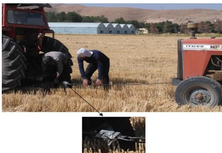
شکل ۲- آزمایش دو تراکتوری برای اندازه گیری نیروی کشش Fig. 2. (a) RNAM method of measuring the draft by two tractor
