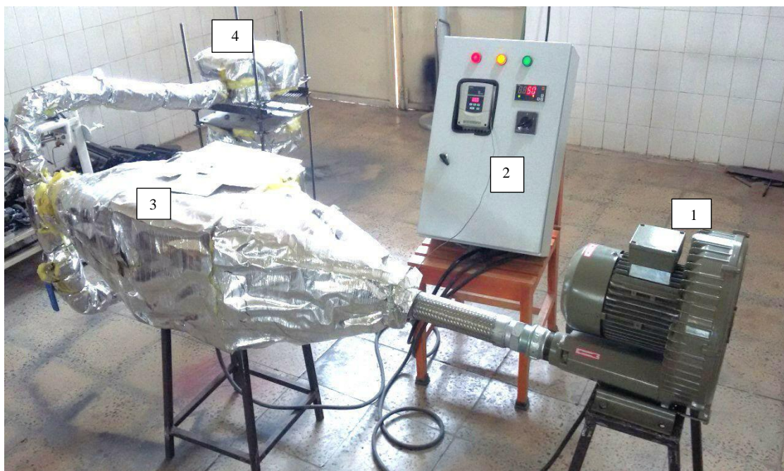
شکل ۱- سامانه خشک‌کن: (۱) دمنده هوا، (۲) سیستم کنترل‌کننده دما و سرعت هوای خشک‌کن، (۳) گرم‌کننده الکتریکی هوا، (۴) پلنوم و نازل‌ها Fig.1. Drying system: 1) Air blower, 2) Air temperature and velocity control unit, 3) Electric heater, 4) Plenum and nozzles
