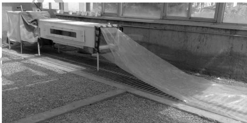
شکل ۱- تصویر تونل باد مورد استفاده برای انجام آزمایش‌های شبیه‌سازی باد.
