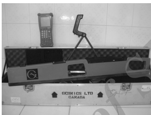
شکل ۳- نمایی از دستگاه القاگر الکترومغناطیس از نوع EM-38 و ساخت شرکت ژئونیکس کانادا.
