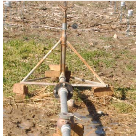
شکل ۱- محل قرار گرفتن قوطی های جمع کننده آب و آبیاش در شبکه بندی انجام شده به فواصل ۲/۵ متر.
