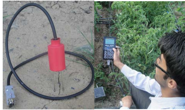
شکل ۱- نمای از دیتالاگر و سنسورهای یک متری
