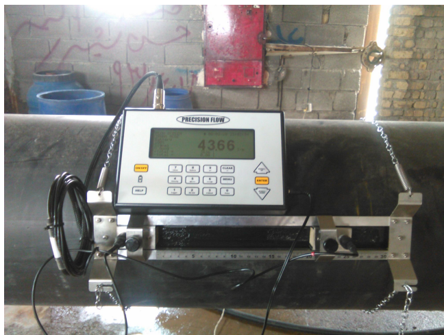
شکل 2- پایش دبی لحظه‌ای در ایستگاه پمپاژ
