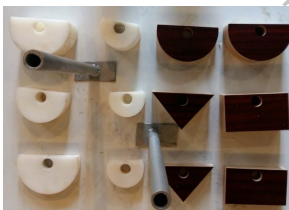
شکل 5- چند نمونه از مدل اجسام شناور پلاستیکی و چوبی با هندسه‌های مختلف به کار رفته در آزمایشگاه
