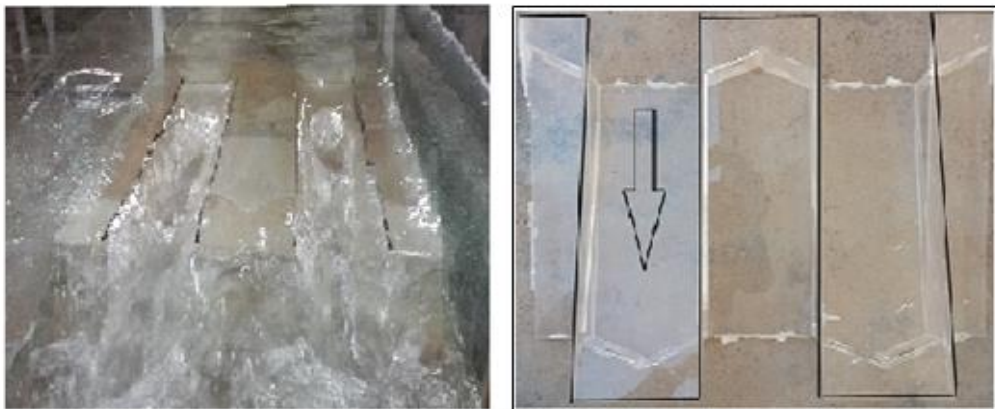
شکل ۳- نمایی از سرریز کلید پیانویی
