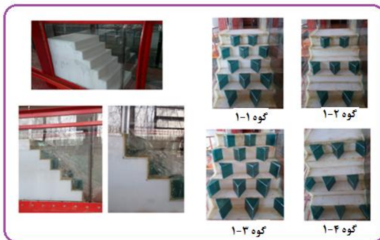
شکل ۴- هندسه و چیدمان‌های سرریز پلکانی همراه با المان گوه‌ای در مطالعه آزمایشگاهی
