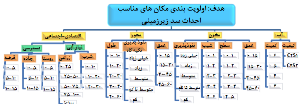
شکل ۱۱- ساختار جریان تصمیم گیری تحلیل سلسله مراتبی مورد استفاده در اولویت بندی محورها
