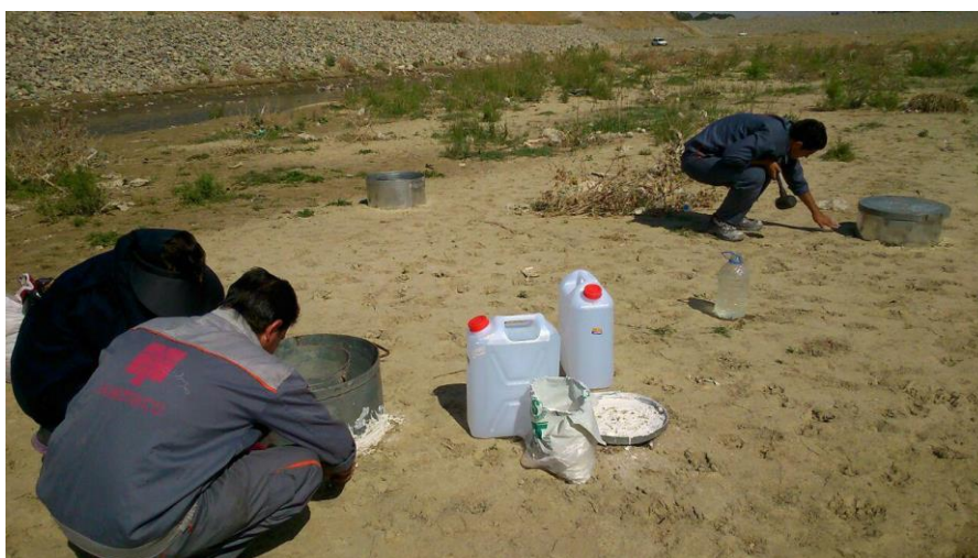
شکل ۱- نمونه ای از آزمایش نفوذپذیری با استوانه‌های مضاعف در محل انجام آزمایش
