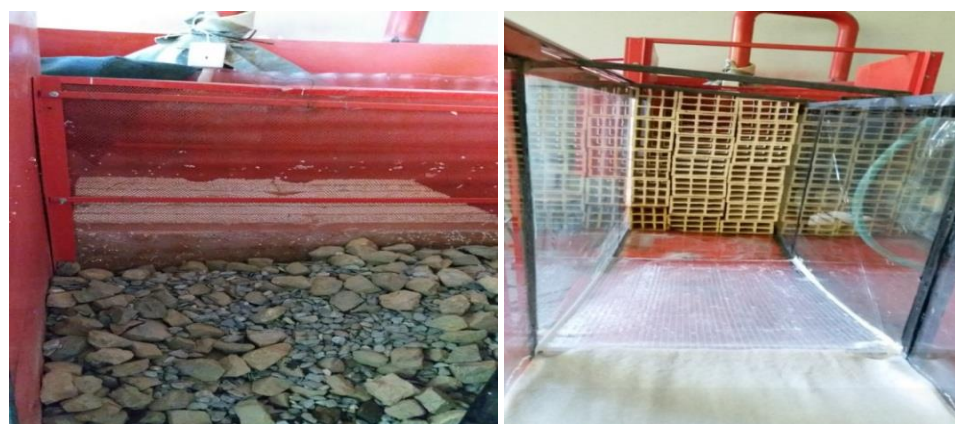
شکل ۲- مصالح استفاده شده برای کاهش تلاطم کانال
