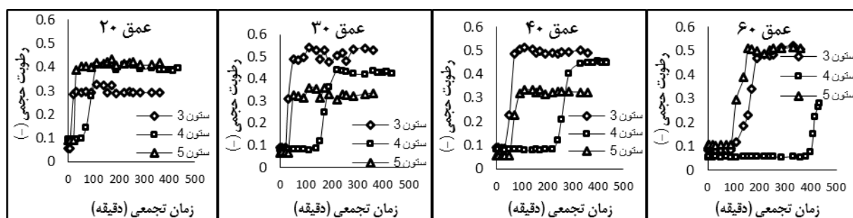
شکل ۵- مقایسه حرکت جبهه رطوبتی در ستون سه، چهار و پنج در عمق‌های مختلف تحت تاثیر بافت‌های مختلف خاک
