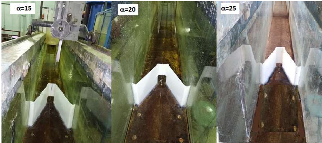
شکل ۱- نمایی از مدل‌های سرریز کنگره‌ای دوزنقه‌ای تک سیکل - درپچه
