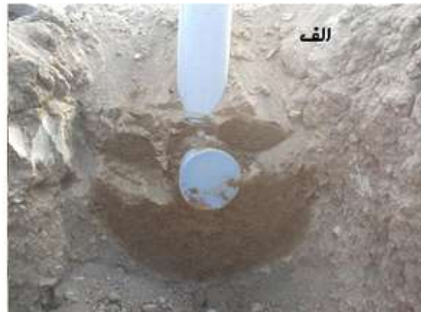
شکل ۳- (الف) جبهه رطوبتی ایجاد شده و (ب) استفاده از چهارچوب مشبک برای اندازه گیری ابعاد پیاز رطوبتی
