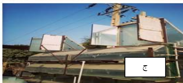
شکل ۳- نمایی از مخازن در حالات مختلف؛ (الف)، بسته بودن آینه و وجود عایق؛ (ب)، بسته بودن آینه و عدم وجود عایق؛ (ج)، باز بودن آینه‌ها و عدم وجود عایق؛ (د)، باز بودن آینه‌ها و وجود عایق
