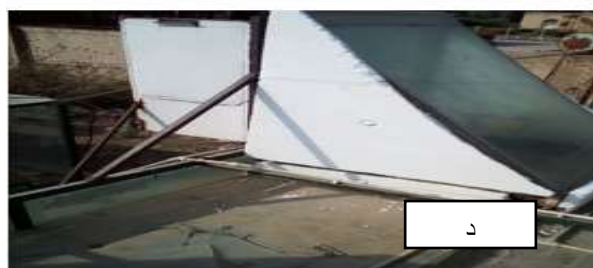
شکل ۳- نمایی از مخازن در حالات مختلف؛ (الف)، بسته بودن آینه و وجود عایق؛ (ب)، بسته بودن آینه و عدم وجود عایق؛ (ج)، باز بودن آینه‌ها و عدم وجود عایق؛ (د)، باز بودن آینه‌ها و وجود عایق
