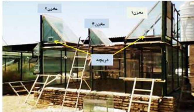
شکل ۲- نمایی از مخازن تقطیری گوه‌ای شکل
