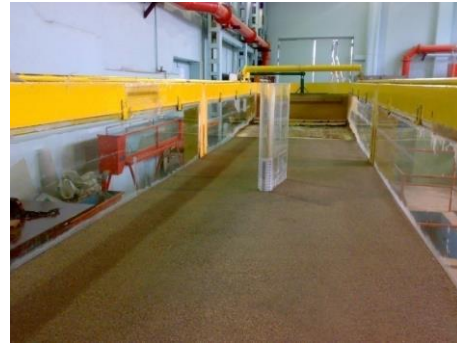
شکل ۱- مدل آزمایشگاهی، الف: کانال آزمایشگاهی همراه با پایه، ب: طرح شماتیک پایه و صفحات مستغرق
