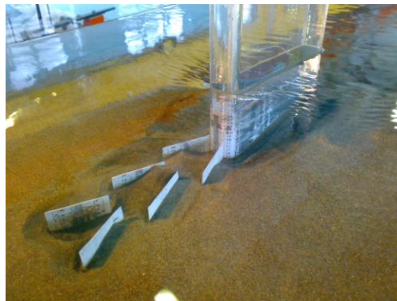
شکل ۶- انتقال رسوب در مدل آزمایشگاهی پایه همراه با صفحات مستغرق
