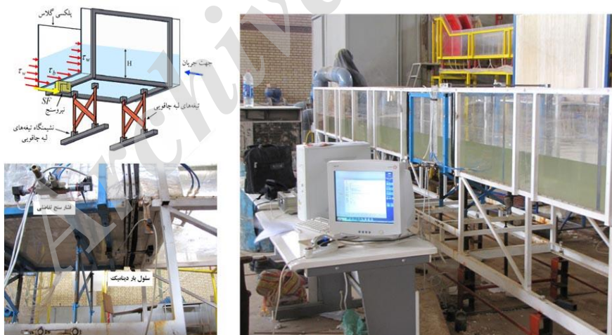
شکل ۱- نمایی از فلوم لبه چاقویی و اجزای تشکیل دهنده سیستم اندازه‌گیری
