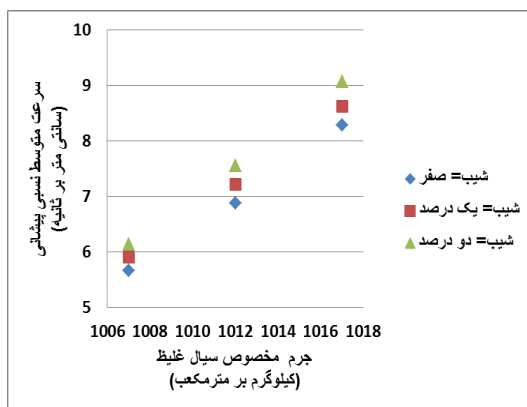
شکل ۳- تغییرات سرعت نسبی پیشانی بر اساس جرم مخصوص سیال غلیظ به ازای دبی سیال پیرامون ۲ لیتر بر ثانیه و دبی سیال غلیظ ۱/۵ لیتر بر ثانیه
