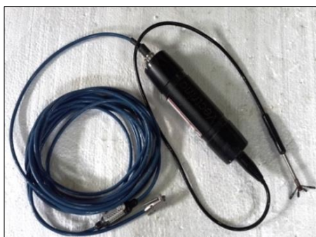
شکل ۵- نمایی کلی از دستگاه سرعت سنج Vectrino +
