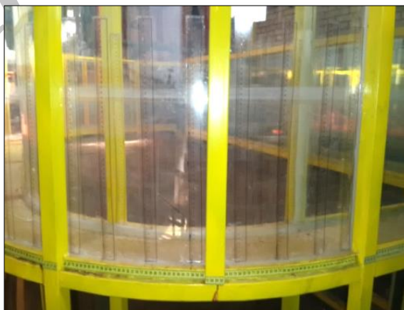
شکل ۴- اشل اندازه گیری عمق جریان غلیظ
