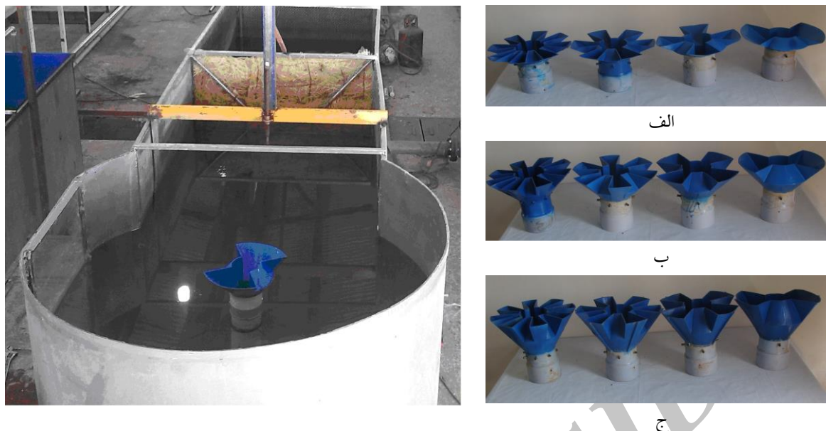
شکل ۳- نمایی از سیستم آزمایشگاهی و مدل‌های سرریز مورد استفاده (الف) - سرریزهای تاج دندانه‌ای با شیب کلید (Z) معادل ۰/۵، (ب) - سرریزهای تاج دندانه‌ای با شیب کلید (Z) معادل ۱، (ج) - سرریزهای تاج دندانه‌ای با شیب کلید (Z) معادل ۱/۵
