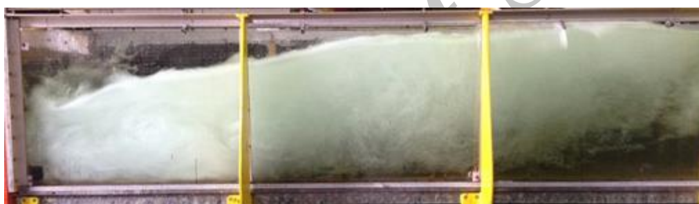
شکل ۳- جریان بعد از جت‌های افقی مستغرق (آزمایش با دبی ۲۵۰ لیتر بر ثانیه، ارتفاع آب مخزن ۲/۲۵ متر و عمق پایاب ۰/۶ متر)
