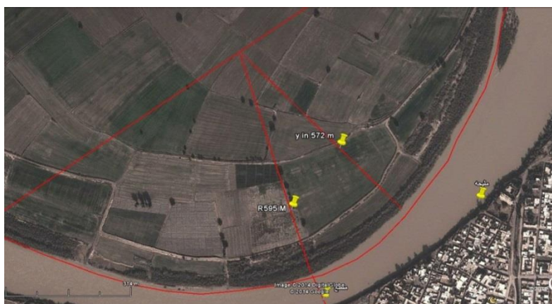
شکل ۴- موقعیت قوس روستای ملیحه برای عملیات اندازه‌گیری توزیع عرضی سرعت و غلظت رسوب معلق
