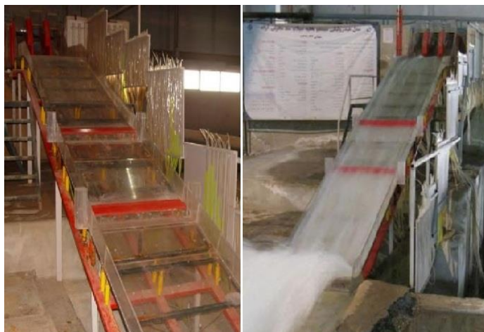
شکل ۱- تصاویری از مدل فیزیکی سرریز سد آزاد
