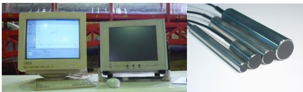
شکل ۴- نمایی از دستگاه سرعت‌سنج DOP2000 و پراب‌های دریافت کننده و صاع کننده
