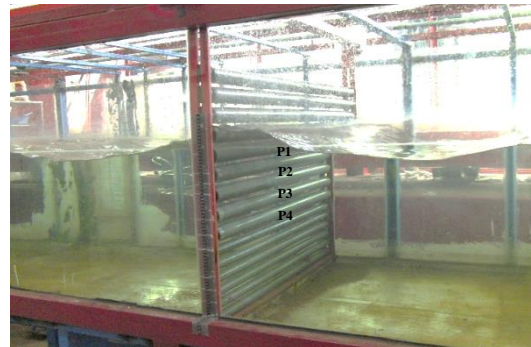
شکل ۵- (الف): نحوه برخورد موج با سازه صفحه موج. (ب): نمایش شیوه جانمایی استوانه‌ها در صفحه موج ترکیبی.
