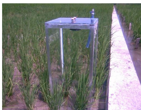
شکل ۱. اتاقک شیشه‌ای نصب‌شده در شالیزار
