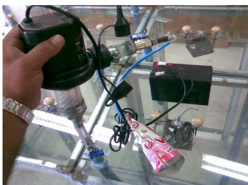
شکل ۲. پمپ، باتری و ظرف نمونه در زمان نمونه‌گیری
