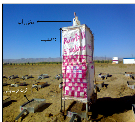
شکل ۳. نمایی از دستگاه شبیه‌ساز باران طراحی شده و مستقر بر کرت فرسایشی
