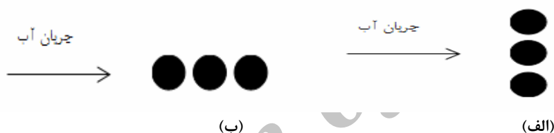
شکل ۵. نحوه قرار گرفتن گروه پایه‌ها: (الف) گروه پایه‌ها در جهت جریان (ب) گروه پایه‌ها عمود بر جریان
