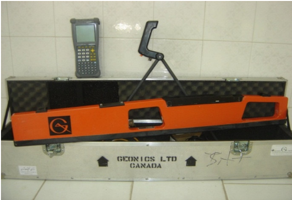
شکل ۳. نمایی از دستگاه القاگر الکترومغناطیس از نوع EM-38 و ساخت شرکت ژئونیکس کانادا
