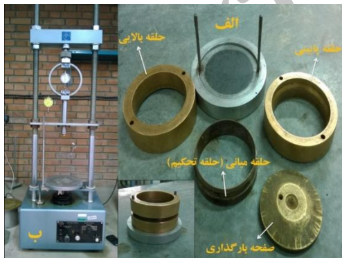
شکل ۲. قالب مخصوص (الف) و دستگاه بارگذاری ویژه (ب) جهت ساخت نمونه‌های آزمایشی
