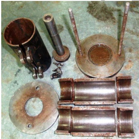
شکل ۱. اجزای مختلف قالب استفاده‌شده جهت تهیه نمونه‌های آزمایشی
