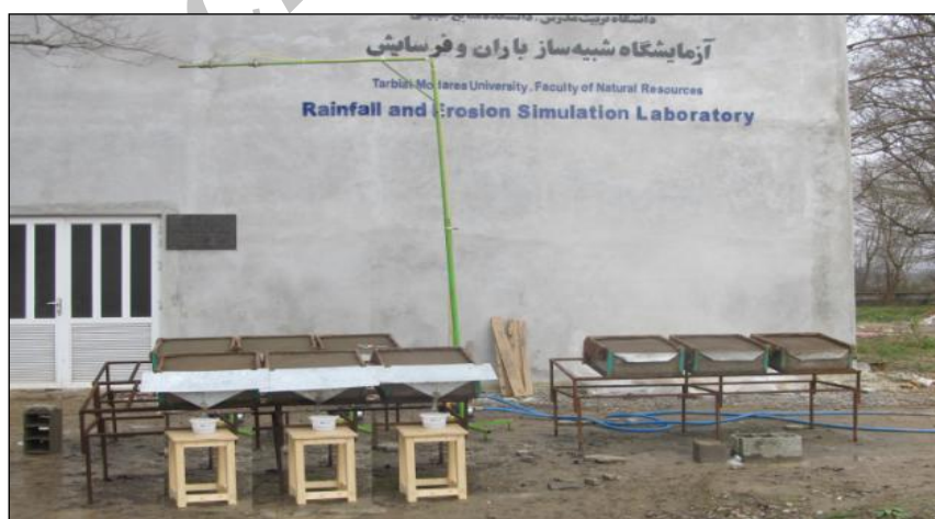
شکل ۱. کرت‌های کوچک فرسایشی و دستگاه شبیه‌ساز باران
