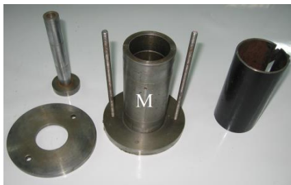
شکل ۱- قالب ویژه تهیه نمونه‌های آزمایشگاهی
