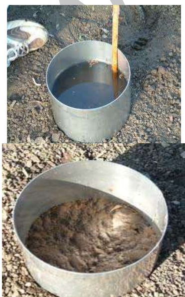
شکل ۳- روش تک استوانه برای اندازه‌گیری نفوذپذیری آب در خاک
