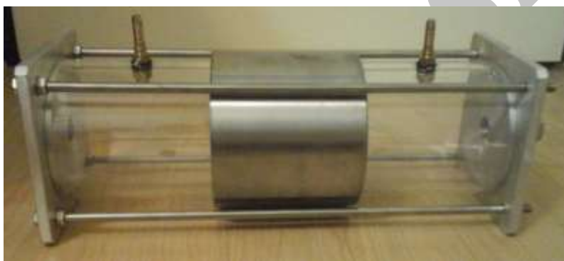
شکل ۵- نمایی از دستگاه فرسایش حفره‌ای مورد استفاده در این پژوهش
