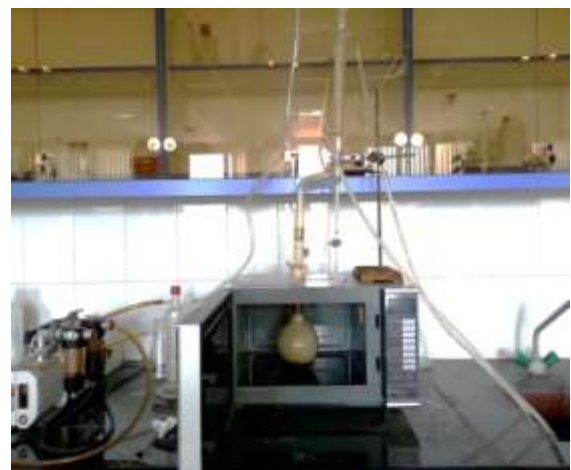
شکل ۱. دستگاه میکروویو تغییر شکل یافته مورد استفاده جهت تابش میکروویو به خاک
